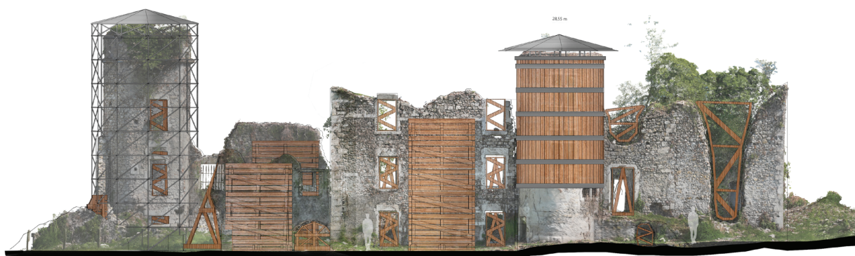
Fig 20, 21 et 22 : ci-dessus - Dessin de façade existante, reconstituée et consolidation provisoire des ruines de la maison forte de La Marcousse - source: OXYGEN ARCHITECTURE
